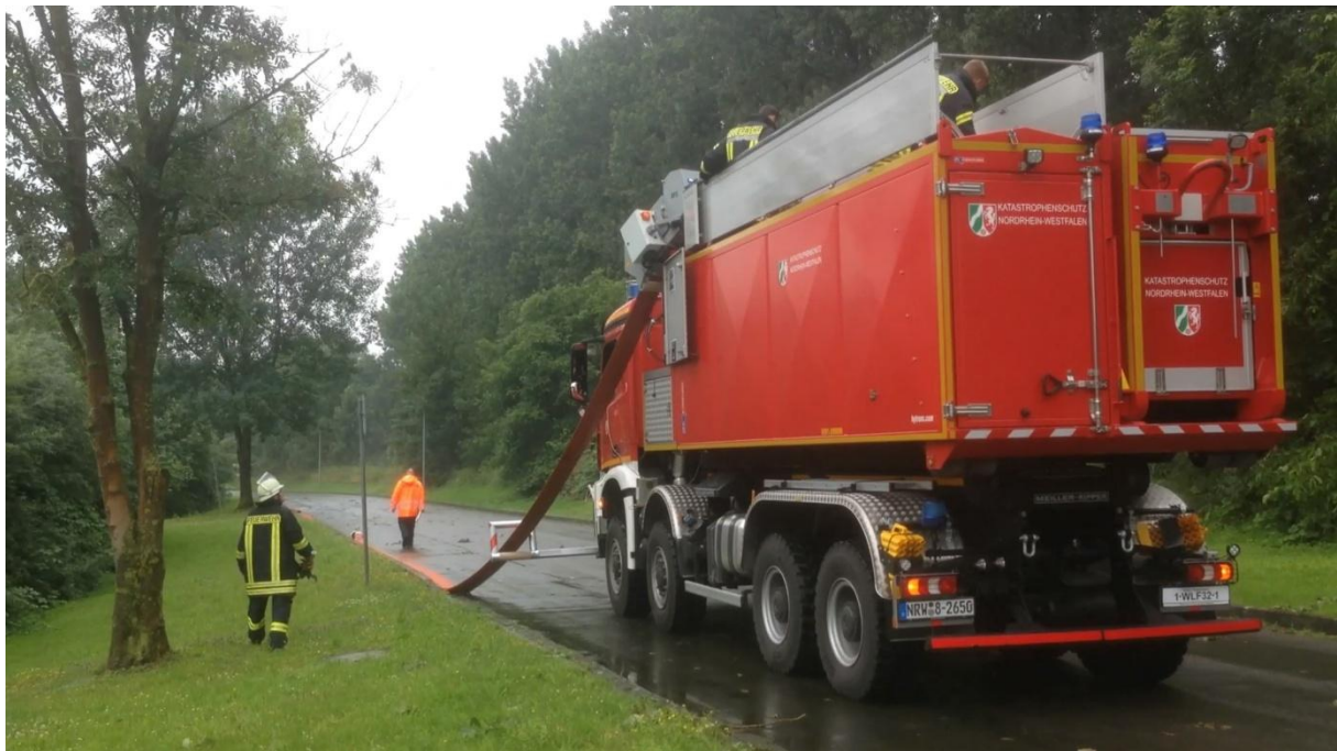
Bild 2: Wechsellader WLF 32 mit aufgesatteltem Container bei der Aufnahme der verlegten Schlauchleitung.
