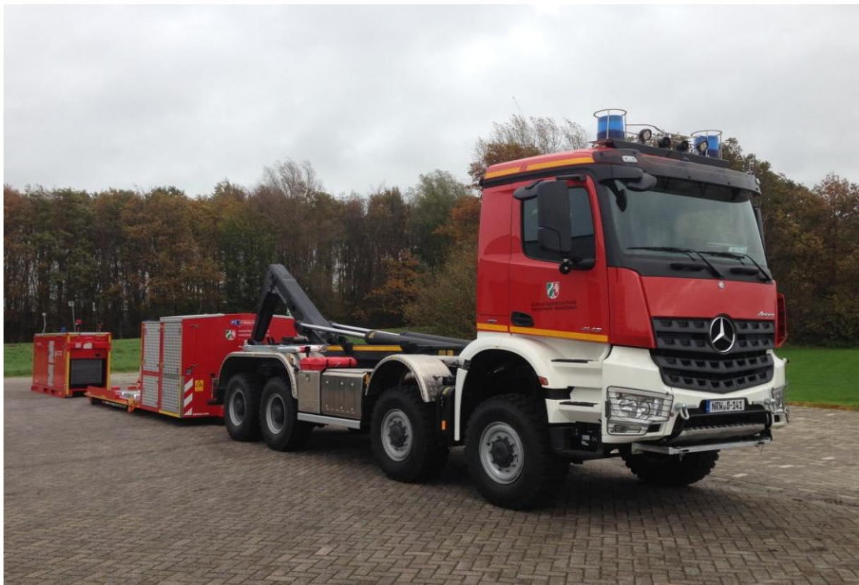
Bild 1: Trägerfahrzeug WLF 32 mit abgesetztem Abrollbehälter und Pumpenmodul Der Wechsellader hat ein Gesamtgewicht von ca. 32 t und ist höchst geländegängig.
