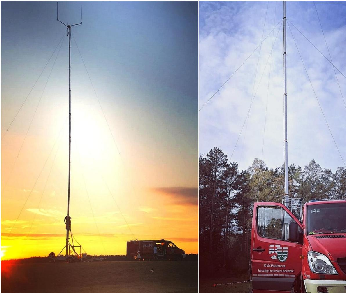
Die Facheinheit Technik verfügt über einen 30 Meter hohen Funkmastanhänger. Auf diesem Funkmast können unterschiedliche Antennen angebaut werden. Damit ist es möglich größere Einsatzstellen abzudecken, auch wenn dort z.B. der Digitalfunk (TMO) nicht ausreichend versorgt ist. Dieses ist insbesondere in der Senne und bei Waldbränden im abgelegenen Gebieten der Fall.
